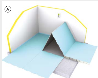
Pose de la sous couche isolante aluminium
